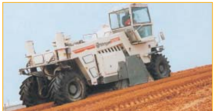
Grâce à ses quatre roues motrices et à des pneus qui "accrochent", le WR 2500 est capable de travailler en grim pant des pentes escarpées.
