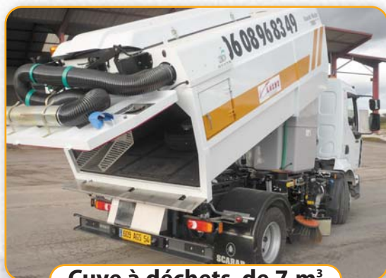
Cuve à déchets de 7 m 3
