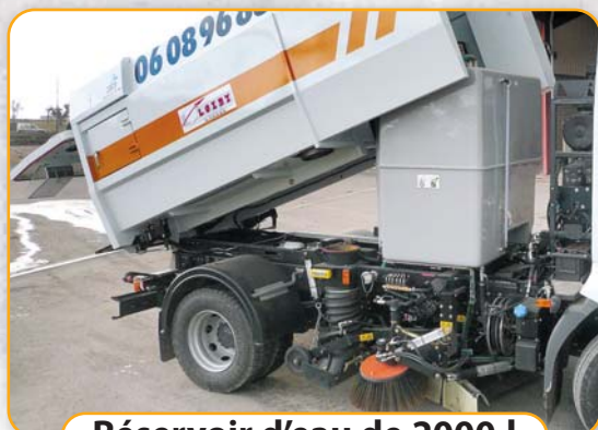
Réservoir d'eau de 2000 l
