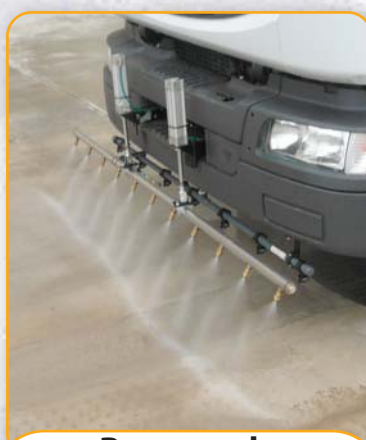
Rampes de lavage haute pression et d'humectage
